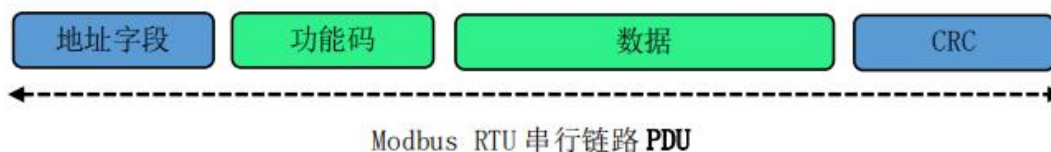
图 7-2 串行链路上的 Modbus 帧
